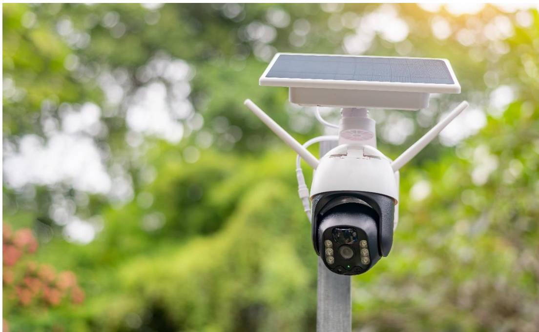
ภาพ 2.2 ระบบ CCTV แบบ Hybrid พร้อมเทคโนโลยีตรวจจับการเคลื่อนไหว (motion sensing) เป็นนวัตกรรมของระบบรักษาความปลอดภัยที่ลดต้นทุนพลังงานและประสิทธิภาพที่เพิ่มขึ้น (Nosiri, Akwiwu-Uzoma, Nmaju, & Elumeziem, 2018)
